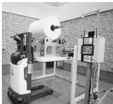
ロール状に巻き付けたフィルムシートなどの重量物を次の工程に正確に搬送する自動搬送・装着ロボット
