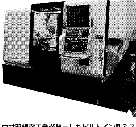
中村留精密工業が発売したビルトイン型ミストコレクター「FogFree(フォグフリー)」(機械正面右奥)
