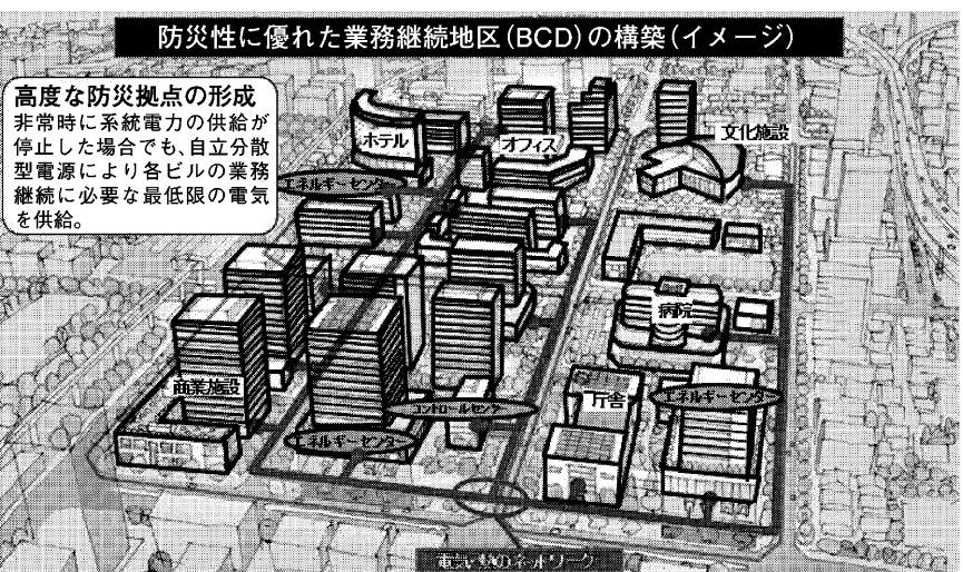
図1 災害時の業務継続に必要なエネルギーの安定供給が確保される業務継続地区(BCD:Business Continuity District)の構築イメージ ※④
