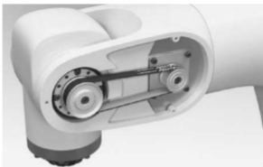
発売予定のロボット用タイミングベルト(三ツ星ベルト提供)
