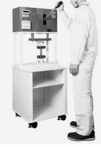
データ連携機能を搭載した引張試験機「PT-IV30」
