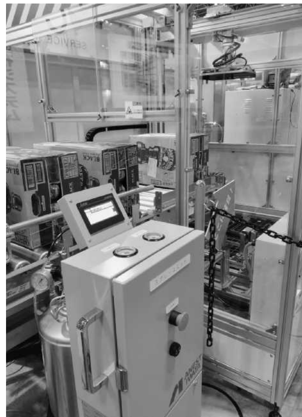
パレタイジングシステムに組み込んで荷崩れを防ぐ水溶性接着剤吹き付け装置「グルーマスター」
