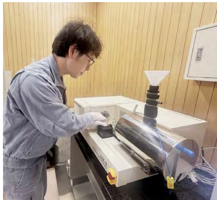
新たに導入したレーザー干渉計は測定時間も短く効率面にも寄与する
