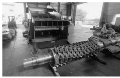
組み付け段階前の破砕機
