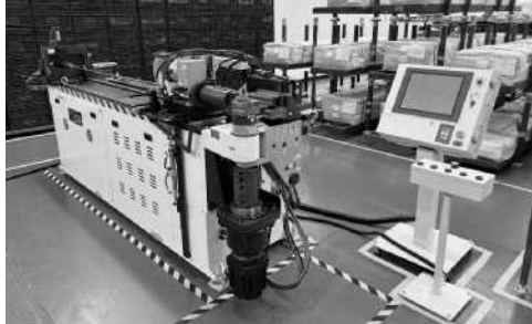
タイ工場に導入したパイプベンダー
