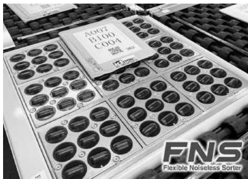
フレキシブルノイズレスソーターは 小物・軟包装品の仕分け作業を自動 化する
