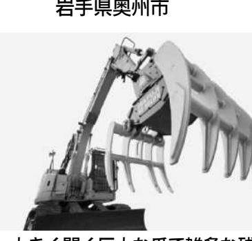
大きく開く巨大な爪で雑多な残材を余すことなくつかんでいくグラップルフォーク
