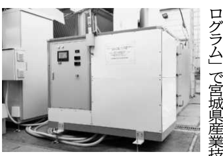
実証実験機では廃棄物用焼却炉の冷却熱で安定した発電を確認
