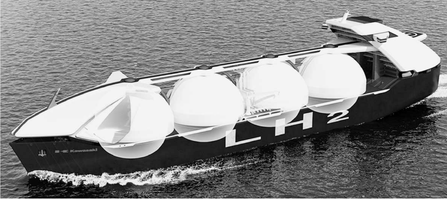
川重は容量16万m 3 の液化水素運搬船「イメーション」を30年ごろに商用化する
