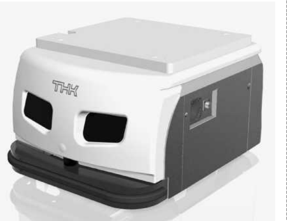
THKはけん引能力を同社従来製品比で2倍の1Tに高めた「SIGNAS」で重量物搬送の自動化ニーズを取り込む
