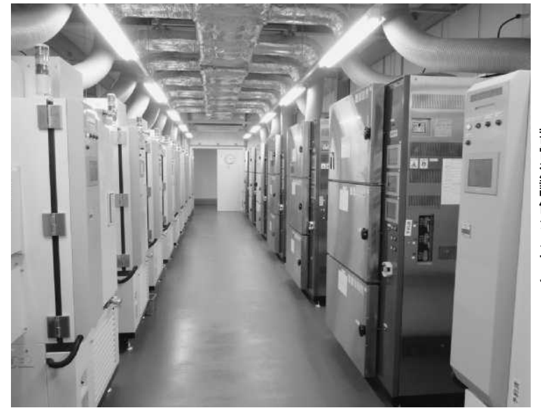
蓄電池評価システム
