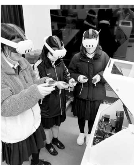
鳥羽商船高等専門学校で実施されたデジタルツインを活用したモノづくり教育の実践の様子。複合現実感ゴーグルと小型デジタル工作機械を活用したモノづくり実習。
