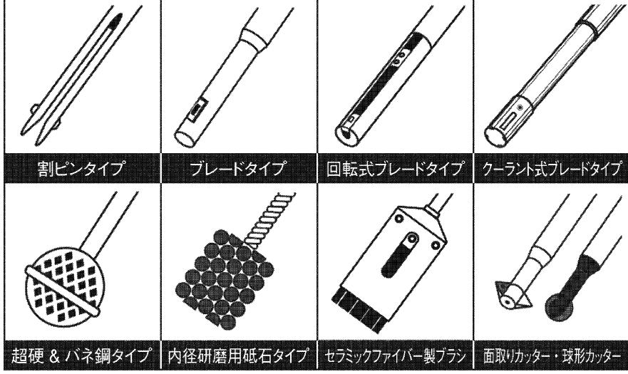
図2 専用機を使ったバリ取り自動化方法
