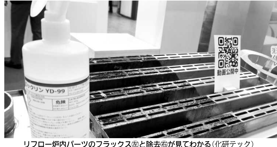
リフロー炉内パーツのフラックスと除去音が見てわかる(化研テック)
