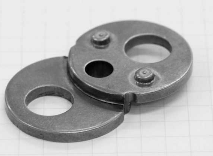
【写真2】 ●スパーギアカム部 材質：SCM415 素材板厚：5.3mm つぶし後板厚：2.7mm 使用プレス：MORI FB650 (秦野精密提供)
