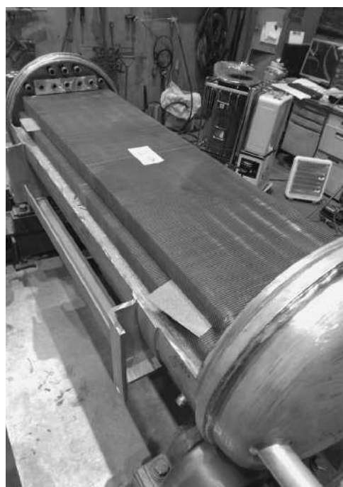
●水素吸蔵合金タンク ●タンクの内部
