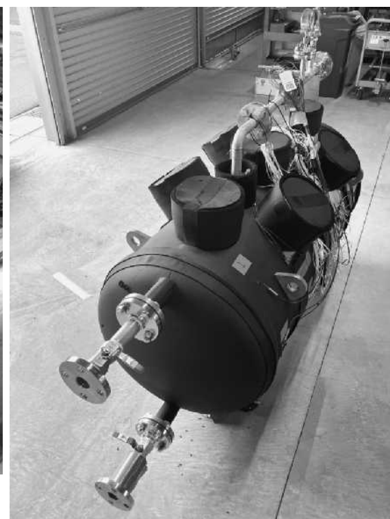
都心の地域熱供給プラントに導入された「Hydro Q-BiC Storage」
