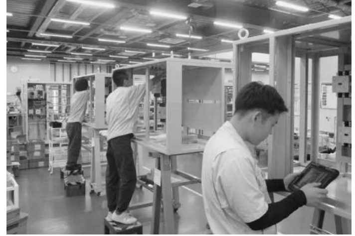
製造工程を管理することで生産品を動かさない「交互生産」を可能にした
