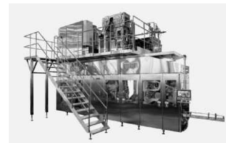
1.5リットル用りんが型紙容器成形無菌充填機「UP-FUJ1-LA82」
