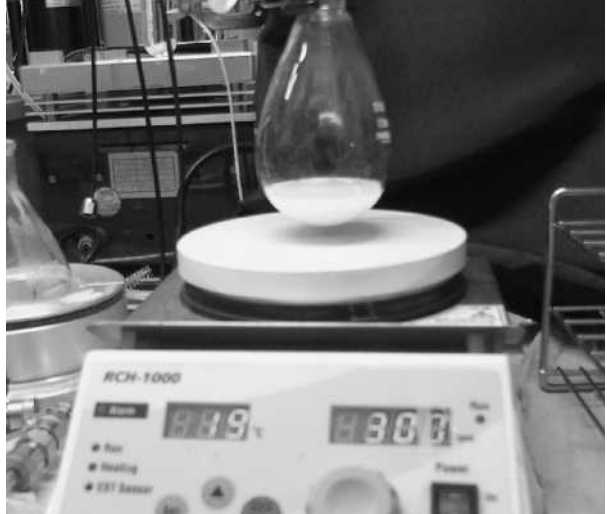
カルバミン酸の懸濁液。イソホロンジアルミン(IPDA)の水溶液に大気を通すとCO 2 と反応してカルバミン酸ができる
