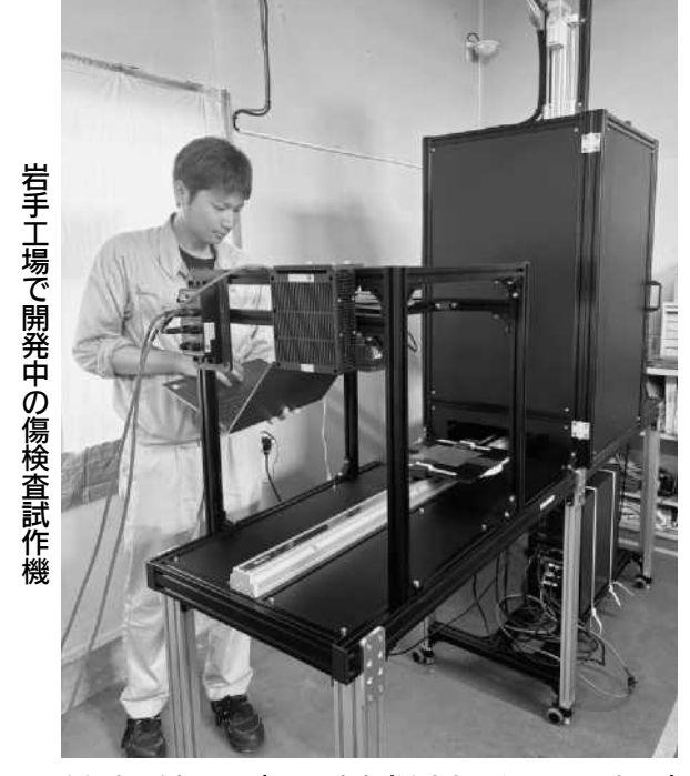
岩手工場にて開発中の検査装置製作機
