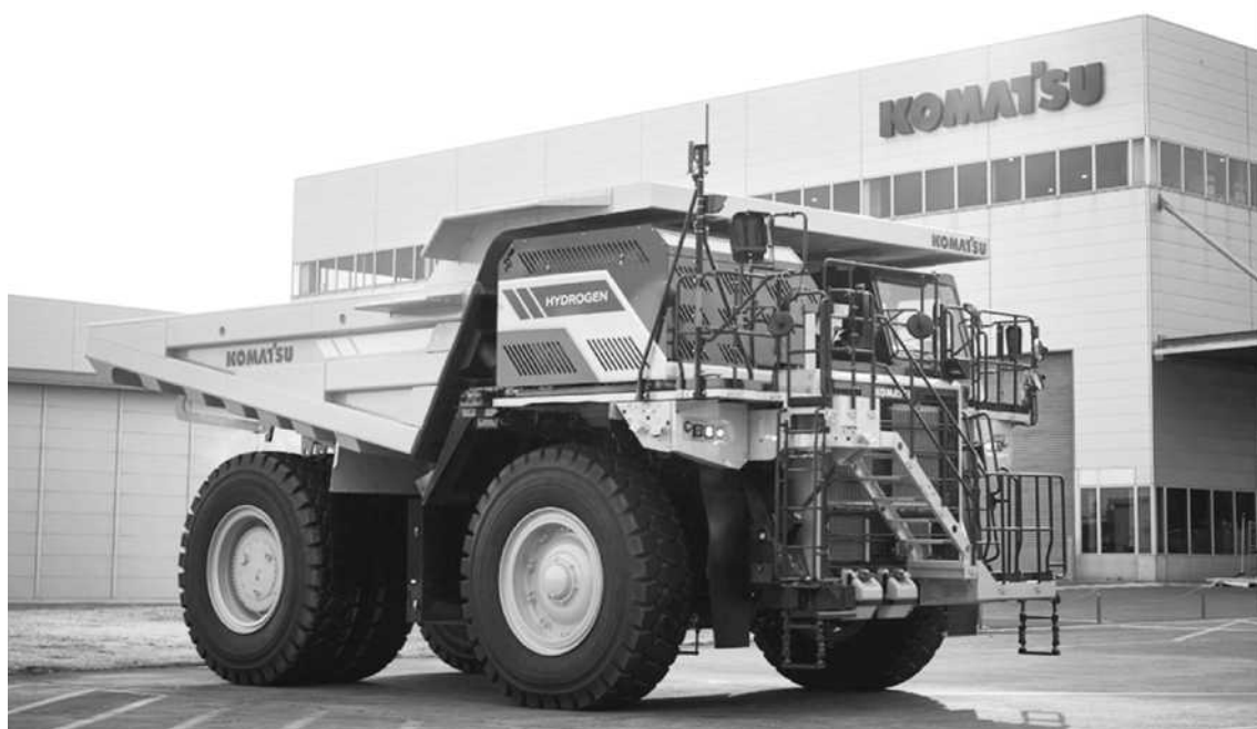
水素専焼エンジンを搭載した大型ダンプトラックのコンセプトマシン(コマツ)
