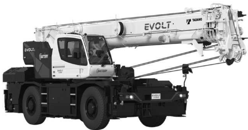
フル電動ラフテレーンクレーン「EVOLT eGR-250N」(タダノ)
