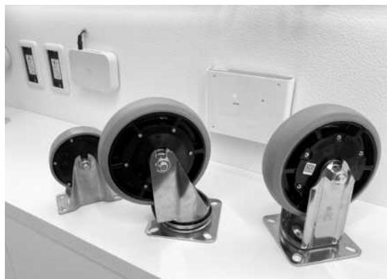
ユーワイの「IOTセンサキャスター」。キャスターの回転で発電するため、外部電力は不要。ゲートウェーにデータを自動送信し、キャスターの取り付け機器の稼働状況を把握するのに役立つ
