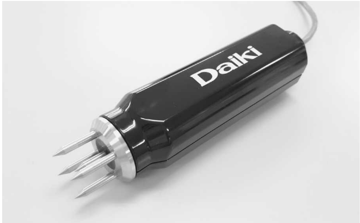
大起理化工業(鴻巣市)が手がける、土壌の水分量を計測できる「DIK-G300 多機能土壌水分センサ」の売れ行きが好調だ。土壌に埋設し、土砂崩れの研究や予測に、長寿命で水分量の多い場所でもセンサーとして役立つ。
