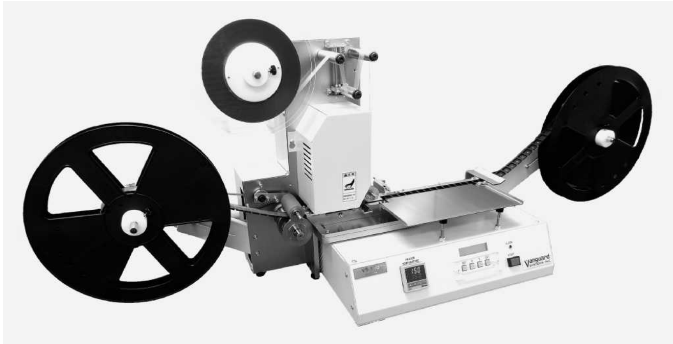
バンガードシステムズ(所沢市)は、テーピングマシン「VS-120」を手がける。ロングセラー商品で、電子部品等をエンボスキャリアテープ内に手動で挿入しカバーテープをシール・テープフィールド・巻き取りまで自動で行える。画像センサの追加も可能だ。
