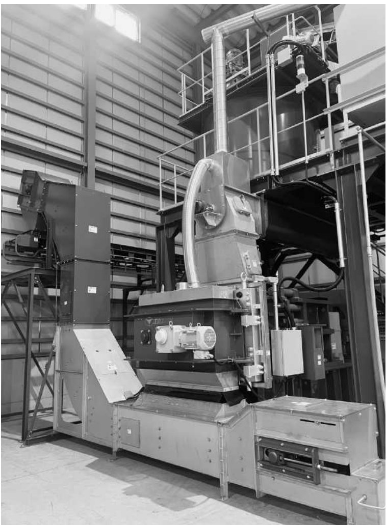
タジリ(深谷市)の廃棄物固形燃料(RPE)製造装置「ウエストポータ」は、シュレッダータストや廃プラスチックのリサイクル推進に貢献する。「約半年前から海外からの問い合わせが来ている」(田尻洋社長など、好調だ。
