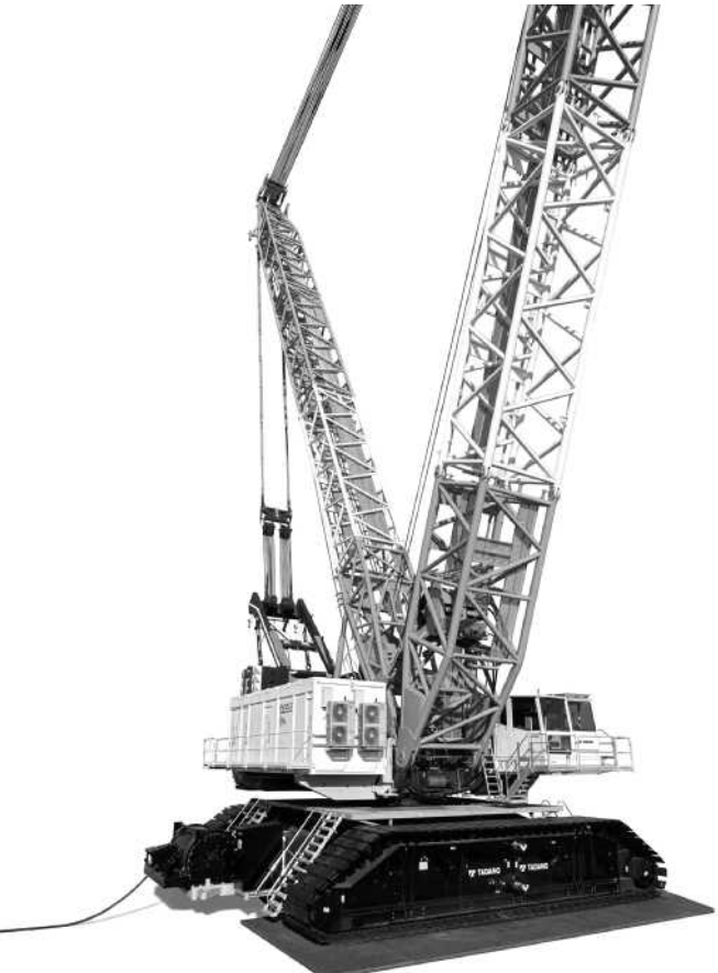
タダノの有線式電動超大型クローラークレーン「EVOLT CC88.1600-1」
