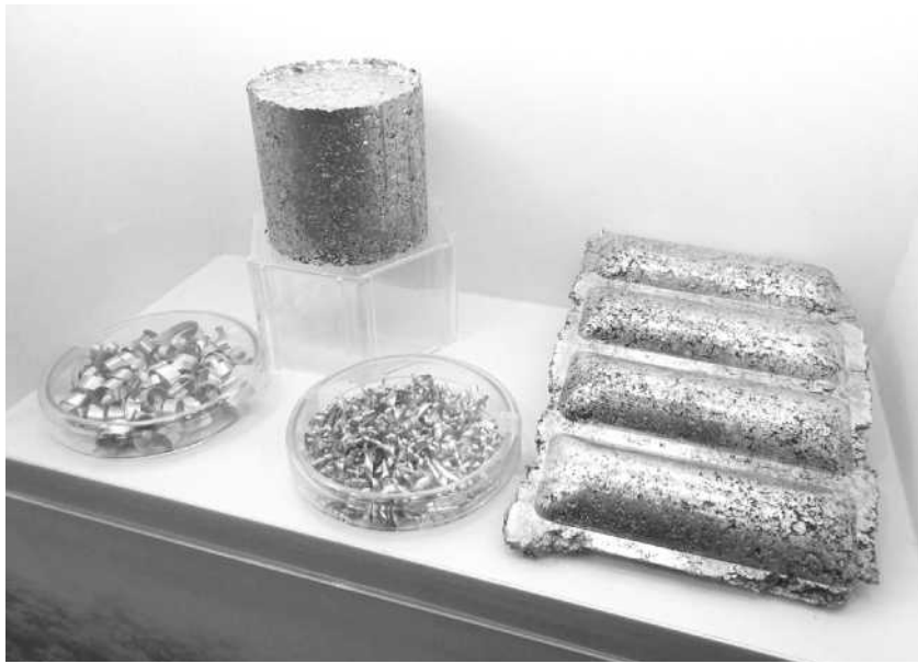
アルミ製品を加工した際に出る切削くずは、再生利用される
