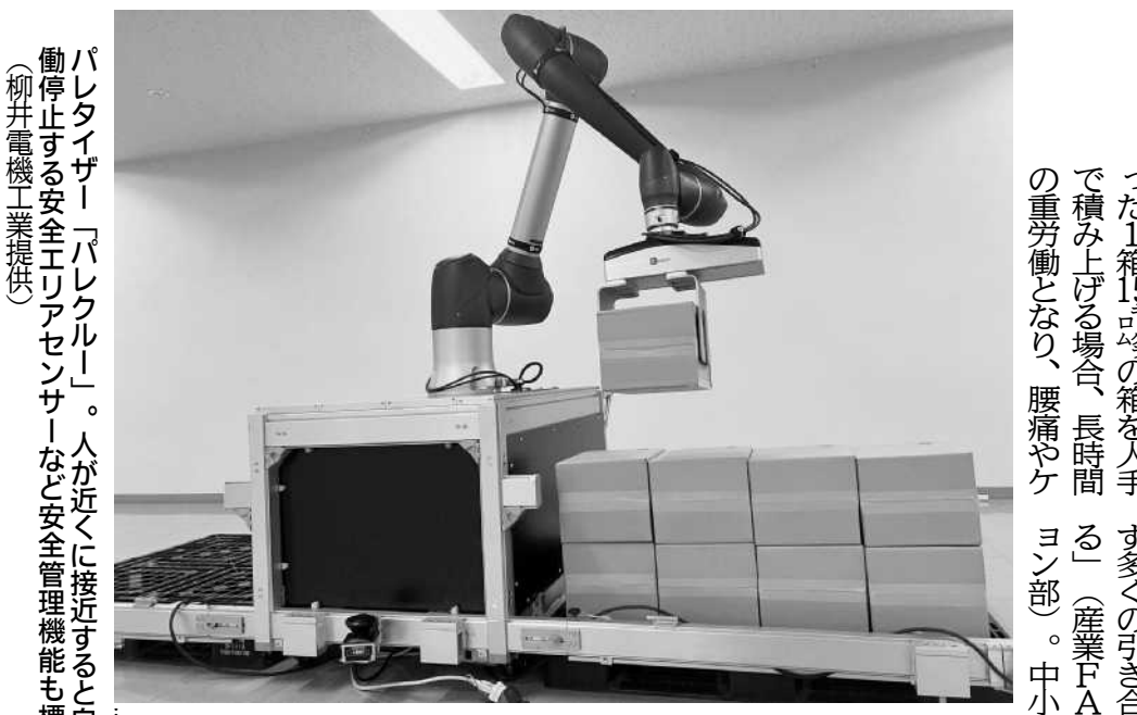
パレタイザー「パレクル」。人が近くに接近すると自動で稼働停止する安全エリアセンサーなど安全管理機能も標準搭載。(柳井電機工業提供)
