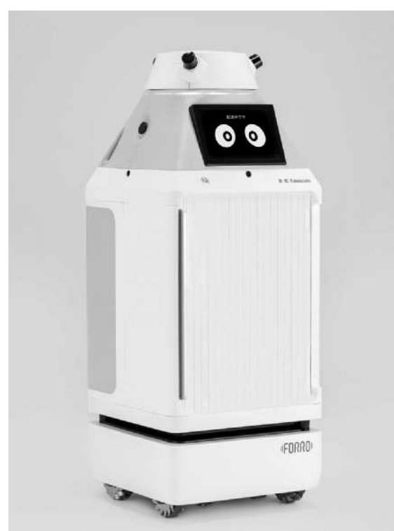
製品は簡略化したインターフェースで誰でも使える操作性を有している。自律走行性能で障害物との接触は99%生じなく、混雑時は徐行するなど安全走行を実現している。また、遠隔サポートで監視体制の提供も可能。導入しやすいサブスクロプションでデリバリーロボットとしてのサービスを提供し、初期導入費の抑制と、導入の迅速化に対応する。
