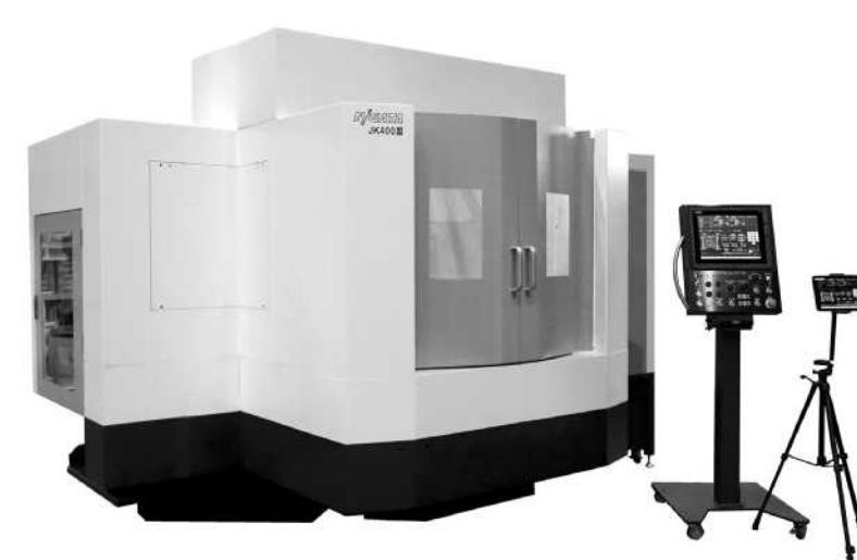
半さに配慮したシンメトリーでスクエアな造形は、正面スプラッシュガードの新たな装備によりフルカバー化され、中型フライス盤のオーセンティック（本物感）なたずまいを嫌みなくデザインしている。ワーク段取り・機内アクセス・チップパッケージットなどは動線を意識し、ホワイトを基調に、ベースの黒、開閉部グレーのカラーバランスでエリアごとの造形をしている。
