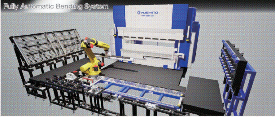
ドア枠材やパネル材の完全自動曲げシステムを披露
