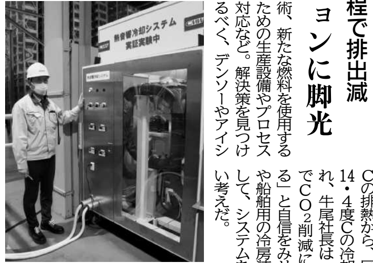
中央精機と東海大学が共同開発した、熱音響冷却システム。熱の力で発生した音波を使って冷却熱を生み出す
