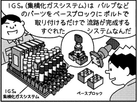
IGS。(集積化ガスシステム)はバルブなどのパーツをベースブロックにボルトで取り付けるだけで流路が完成するすぐれたシステムなんだ
